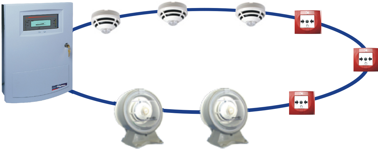
Fig. 26: Vigilon loop wiring
